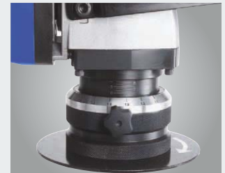
Fasenbreite von 0 - 10,6 mm stufenlos einstellbar bequeme und exakte Einstellung der Fashöhe dank leicht lesbarer Skala 3 Fashenwinkel 30 ° / 37,5 ° / 45°
