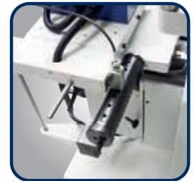
▶ Dübelbohrereinrichtung mit Rasterteilung 16 / 22 / 25 / 32
