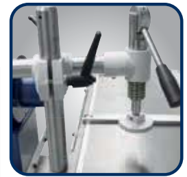
▶ Manueller Exzentrerspanner mit großem Auflageteller zum Fixieren des Werkstücks
