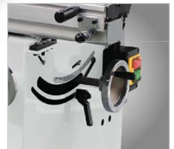
Sägeblattschwenkung von 0° bis 45°, bequem verstellbar über Drehknopf und Skala per Zahnstangenmechanismus
