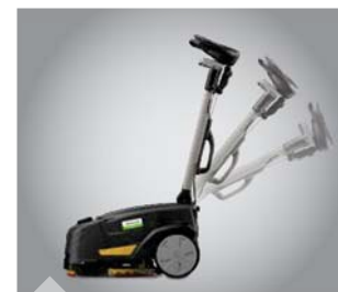
Mit flach gestelltem Handgriff Absaugung in der Vorwärtsbewegung Mit aufrecht gestelltem Handgriff Absaugung in der Rückwärtsbewegung
